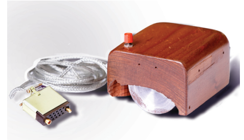
Abbildung 2.20: Original Maus erfunden von Douglas Engelbart 1963 (2.21)
